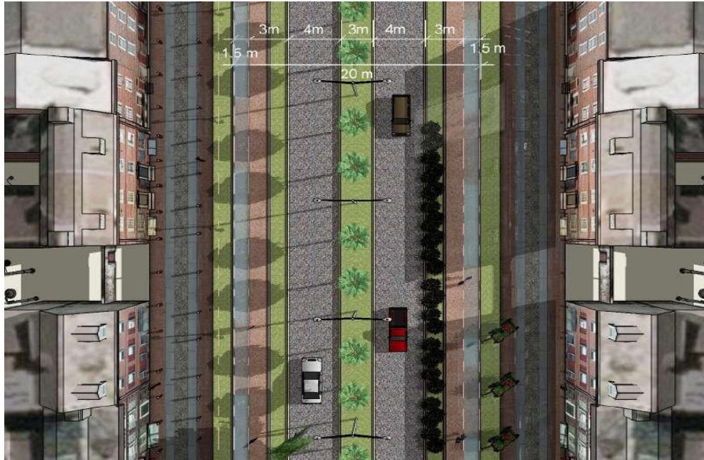
Gambar 101. Penampang Jaringan Jalan dengan ROW 20 m Sumber: Kementerian Perindustrian, 2023
