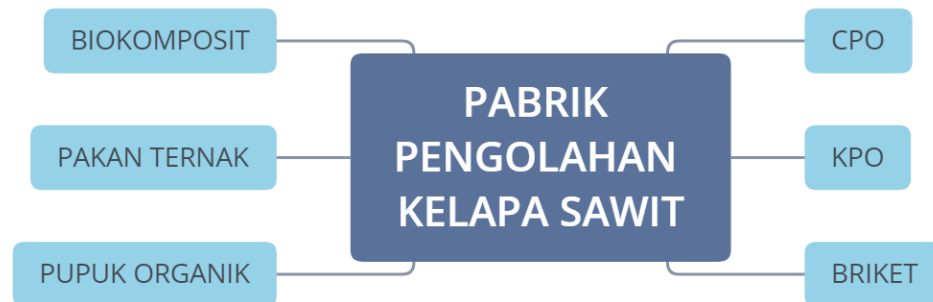
Gambar 139. Pohon industri pabrik pengolahan kelapa sawit
